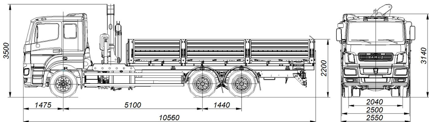
Размеры для автомобиля снаряженной массы: - с шинами 315/80R22,5
