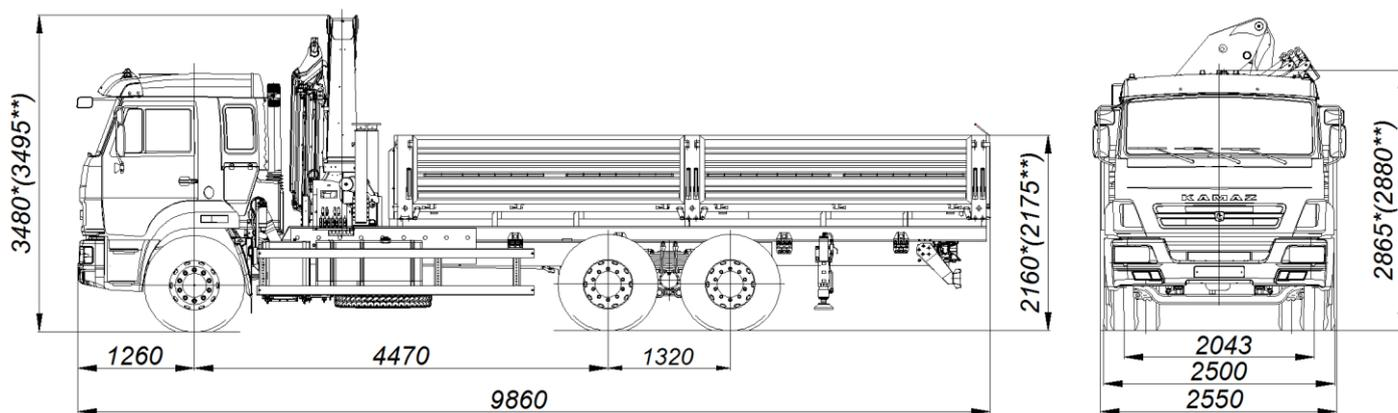
Размеры для автомобиля снаряженной массы: \* - с шинами 11.00 R22,5/ \*\* - с шинами 11.00 R20
