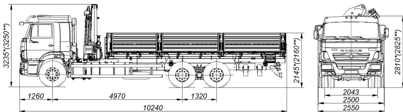
Размеры для автомобиля снаряженной массы: \* - с шинами 11.00 R22,5/ \*\* - с шинами 11.00 R20
