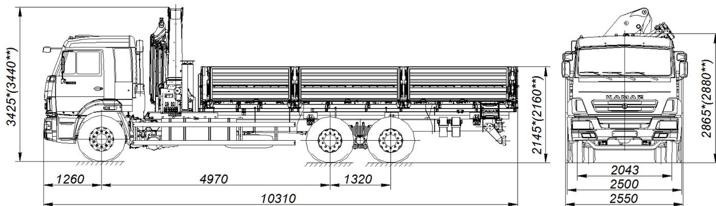
Размеры для автомобиля снаряженной массы: \* - с шинами 11.00 R22,5/ \*\* - с шинами 11.00 R20
